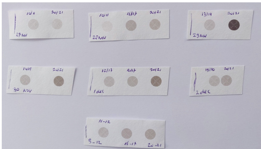
Figuur 5. Glasvezelfilters met per uur een 'spot' als resultaat. Donkere spots in de avonden.
