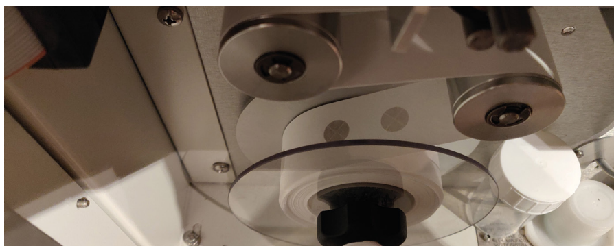
Figuur 3. De glasvezel filterband met de zichtbare meet spots
