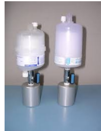
Afbeelding 12: De Zero Filter Calibration Kit BX-302 (foto: Met One)
