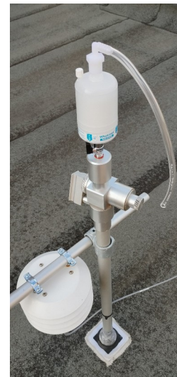
Afbeelding 14: De BX-302 gemonteerd op de PM2.5 sharp cut cyclone
